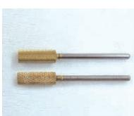
長く使うことで、ピットの表面の刃の部分が磨耗し鋭さを失います。
